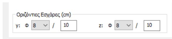
είναι αυτή που ενημερώνει το τεύχος των υπολογισμών και λαμβάνεται υπόψη και υπολογιστικά. Το πρόγραμμα, στην αρχική διαστασιολόγηση ενημερώνει αυτόματα αυτό το πεδίο, αλλά σε περίπτωση τροποποίησης ή τοποθέτησης εξαρχής, πρέπει να το ενημερώσετε «χειροκίνητα».
