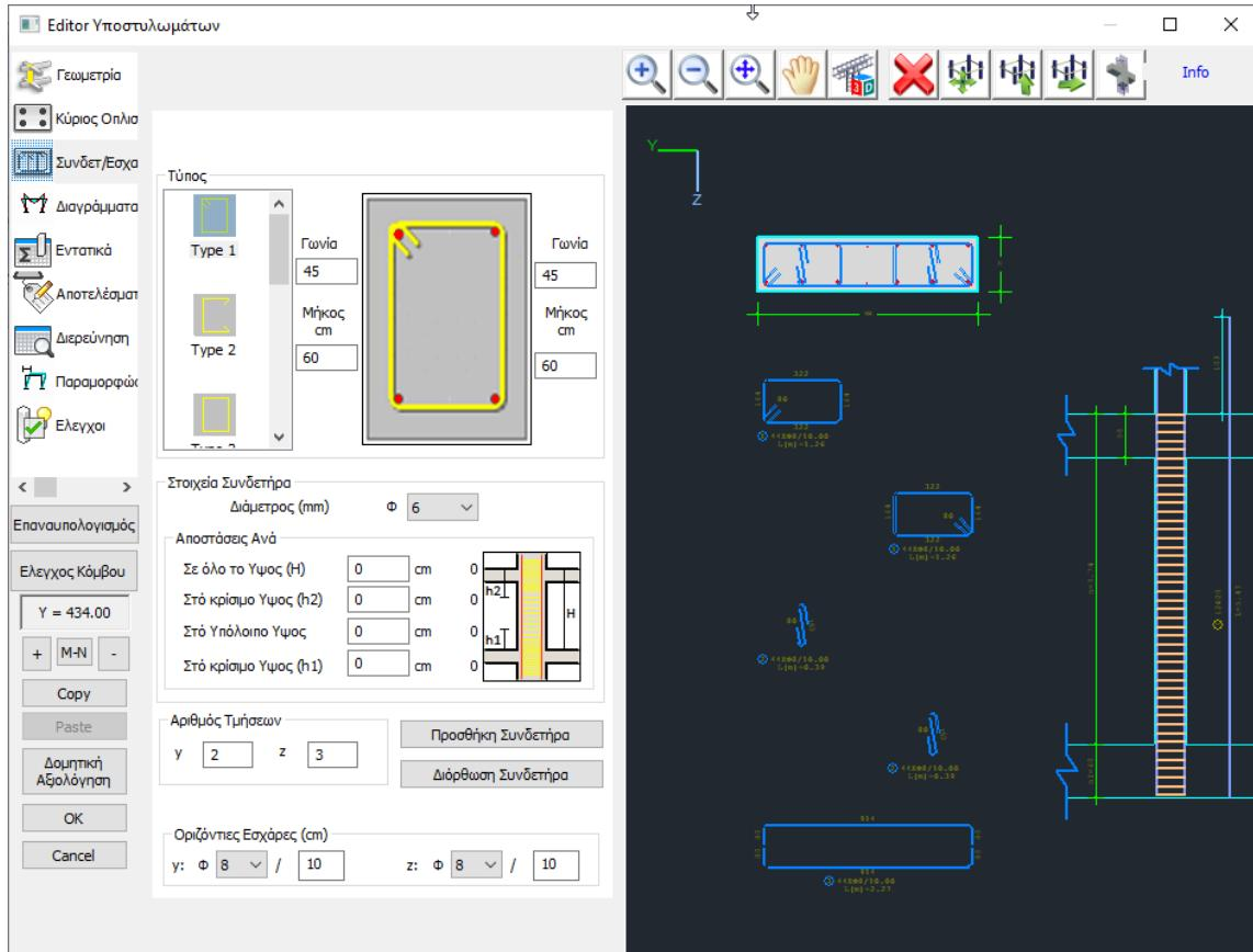
Στο πεδίο Συνδετήρες μπορείτε να πραγματοποιήσετε τροποποιήσεις και επεμβάσεις στους συνδετήρες του υποστυλώματος.
