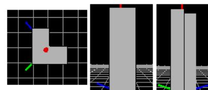
Στο παράθυρο σχηματίζεται η διατομή του υποστυλώματος που διαμορφώνεται με βάση τη γεωμετρία που έχετε επιλέξει και τις διαστάσεις που έχετε εισάγει. Εδώ επίσης βλέπετε τους τοπικούς άξονες γγ και zz της διατομής και μπορείτε να επιλέξετε το σημείο εισαγωγής της (μπλε σημείο). Το επιλεγμένο σημείο εισαγωγής είναι χρώματος κόκκινου.
