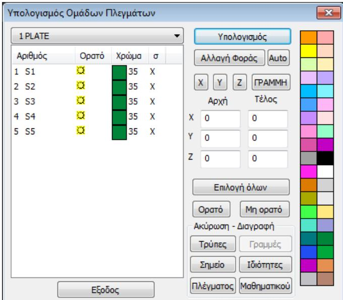
Με το “Υπολογισμός” υπολογίζετε το Meshing.
