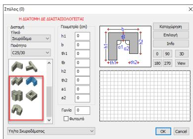
Οι περιπτώσεις των στύλων σχήματος Z , παραμετρικού , σχήματος σταυρού + στύλος και στύλου με οπή ΔΕ διαστασιολογούνται από το πρόγραμμα και στο πάνω μέρος του παραθύρου τονίζεται με την ένδειξη **Η ΔΙΑΤΟΜΗ ΔΕ ΔΙΑΣΤΑΣΙΟΛΟΓΕΙΤΑΙ**
