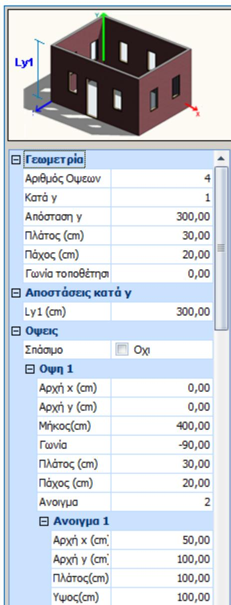
Δημιουργήστε τη γεωμετρία, ορίζοντας τον αριθμό όψεων, τις κατά γ επαναλήψεις (νούμερο ορόφων) και την απόσταση γ (ύψος ορόφων). Το πλάτος και το πάχος αφορά τους τοίχους και η γωνία τοποθέτησης, τη γωνία εισαγωγής στην επιφάνεια εργασίας στο επίπεδο XZ.
