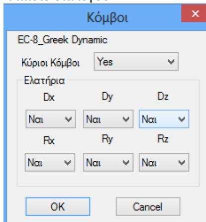
Εδώ μπορείτε να ορίσετε να επιλυθεί ο φορέας σας χωρίς διαφραγματική λειτουργία συνολικά, ακόμα και αν υπάρχουν κόμβοι διαφράγματος, καθώς επίσης και να επιλυθεί πακτωμένος (Ελατήρια Όχι) ακόμα και αν έχει οριστεί ελαστική θεμελίωση.
