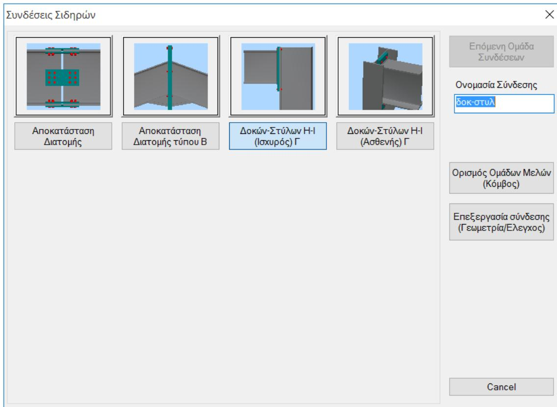
Επιλέξτε για παράδειγμα διαδοχικά το μέλος 30 (υποστύλωμα) και το μέλος 154 (δοκός). Με δεξί κλικ εμφανίζεται το παράθυρο με τους 4 πιθανούς τύπους συνδέσεων. Επιλέγετε την τελευταία (προς τα δεξιά) σύνδεση η οποία αντιστοιχεί σε σύνδεση Δοκού – Στύλου διατομών τύπου Η ή Ι στον ισχυρό άξονα. Ακολούθως θα πληκτρολογήσετε ένα όνομα για τη συγκεκριμένη σύνδεση.
