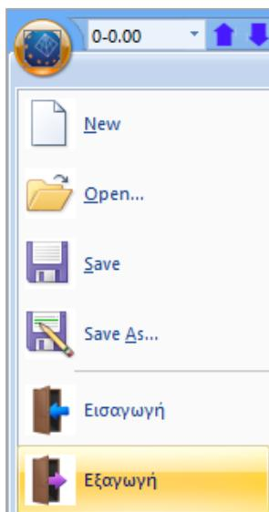
Έτσι, θα πρέπει να κάνετε κλικ στην εντολή “Εξαγωγή” με την οποία εμφανίζεται ένα νέο παράθυρο μέσω του οποίου μπορείτε να κάνετε εξαγωγή του αρχείου SCADA Pro σε αρχείο μορφής \*.dwg του autocad. Στο πεδίο “Save As” επιλέγετε το φάκελο της μελέτης σας να εξάγετε μία τρισδιάστατη μορφή της κατασκευής σας. Για να γίνει αυτό πληκτρολογείτε ένα όνομα στο File name και κατόπιν στο πεδίο “save as type” επιλέγετε τη μορφή 3D\_dwg Files (\*.DWG).
