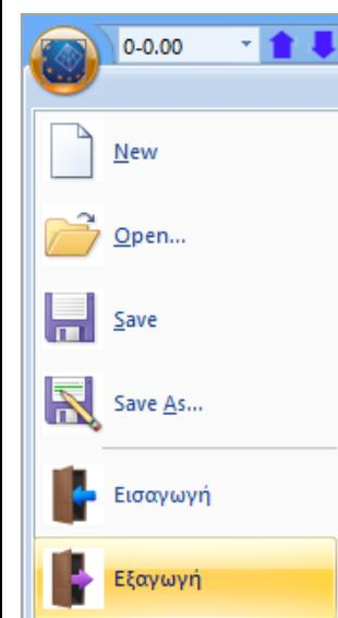
Έτσι, θα πρέπει να κάνετε κλικ στην εντολή "Εξαγωγή" με την οποία εμφανίζεται ένα νέο παράθυρο μέσω του οποίου μπορείτε να κάνετε εξαγωγή του αρχείου SCADA Pro σε αρχείο μορφής \*.dwg του autocad. Στο πεδίο "Save As" επιλέγετε το φάκελο της μελέτης σας να εξάγετε μία τρισδιάστατη μορφή της κατασκευής σας. Για να γίνει αυτό πληκτρολογείτε ένα όνομα στο File name και κατόπιν στο πεδίο "save as type" επιλέγετε τη μορφή 3D\_dwg Files (\*.DWG).
