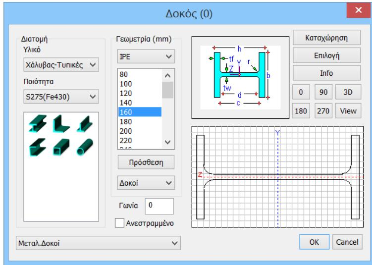
Για να την εισάγετε στην κατασκευή σας κάνετε κλικ στο "οκ" και κατόπιν επιλέγετε κόμβο αρχής και κόμβο τέλους του συγκεκριμένου μέλους πάνω στην κατασκευή σας σε 2D ή 3D. Ετσι σας δίνεται η δυνατότητα να εισάγετε οποιοδήποτε μέλος στο χώρο και να δημιουργήσετε ακόμα και τις πιο σύνθετες κατασκευές.
