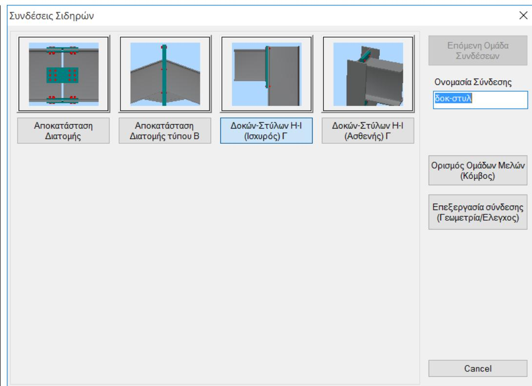
Επιλέξτε για παράδειγμα διαδοχικά το μέλος 30 (υποστύλωμα) και το μέλος 154 (δοκός). Με δεξί κλικ εμφανίζεται το παράθυρο με τους 4 πιθανούς τύπους συνδέσεων. Επιλέγετε την τελευταία (προς τα δεξιά) σύνδεση η οποία αντιστοιχεί σε σύνδεση Δοκού – Στύλου διατομών τύπου Η ή Ι στον ασθενή άξονα. Ακολούθως θα πληκτρολογήσετε ένα όνομα για τη συγκεκριμένη σύνδεση (π.χ. dok\_styl\_asthenis).
