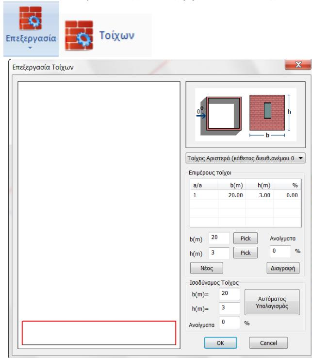
**Σημείωση:** Στις περιπτώσεις εισαγωγής του μεταλλικών φορέων από Τυπικές Κατασκευές, η γεωμετρία των τοίχων εισάγεται αυτόματα από το πρόγραμμα.
