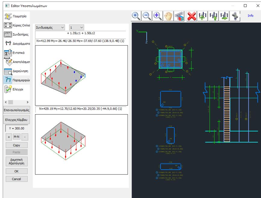
Στο πεδίο Παραμορφώσεις μπορείτε να δείτε πως παραμορφώνονται η άνω και κάτω διατομή του υποστυλώματος, σε κάθε φόρτιση και κάθε συνδυασμό, καθώς και τον οπλισμό που ανάλογα με το αν είναι θλιβόμενος ή εφελκυόμενος συμβολίζεται με μπλε ή κόκκινο αντίστοιχα.
