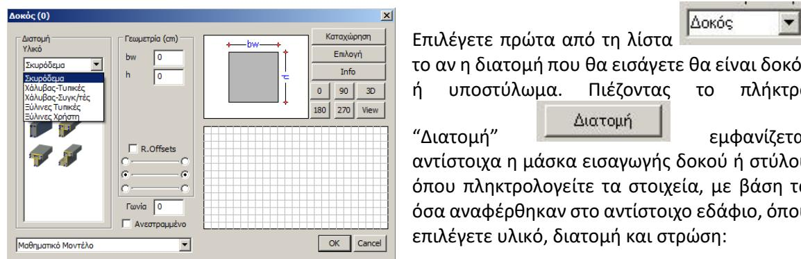
Επιλέγετε πρώτα από τη λίστα το αν η διατομή που θα εισάγετε θα είναι δοκός ή υποστύλωμα. Πιέζοντας το πλήκτρο “Διατομή” εμφανίζεται αντίστοιχα η μάσκα εισαγωγής δοκού ή στύλου όπου πληκτρολογείτε τα στοιχεία, με βάση τα οποία αναφέρθηκαν στο αντίστοιχο εδάφιο, όπου επιλέγετε υλικό, διατομή και στρώση:
