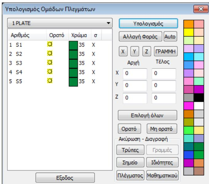
Με το “Υπολογισμός” υπολογίζετε το Meshing.
