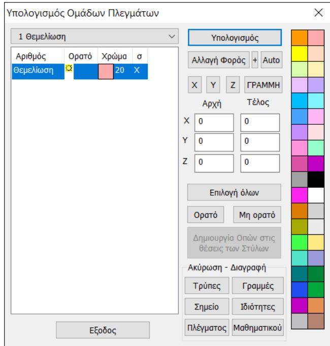
Στην επάνω λίστα του πλαισίου διαλόγου, επιλέγετε το πλέγμα επιφανειακών του οποίου θέλετε να κάνετε τον υπολογισμό. Να σημειωθεί εδώ ότι η κάθε ομάδα πλέγματος, αφορά μία μόνο διακριτή επιφάνεια που έχετε καθορίσει με ένα συγκεκριμένο όριο. Αυτό πρακτικά σημαίνει ότι δεν μπορείτε να χρησιμοποιήσετε το πλέγμα επιφανειακών “plegma” για δύο περιοχές.
