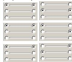
Επιλέγετε τη διατομή της δοκού και το σημείο εισαγωγής (αρχή) με αριστερό κλίκ στην επιφάνεια εργασίας. Πριν επιλέξετε το σημείο τέλους της δοκού, πιέζεται το πλήκτρο TAB, SHIFT, ή CTRL, ανάλογα με το πώς θέλετε να της τοποθετήσετε.
