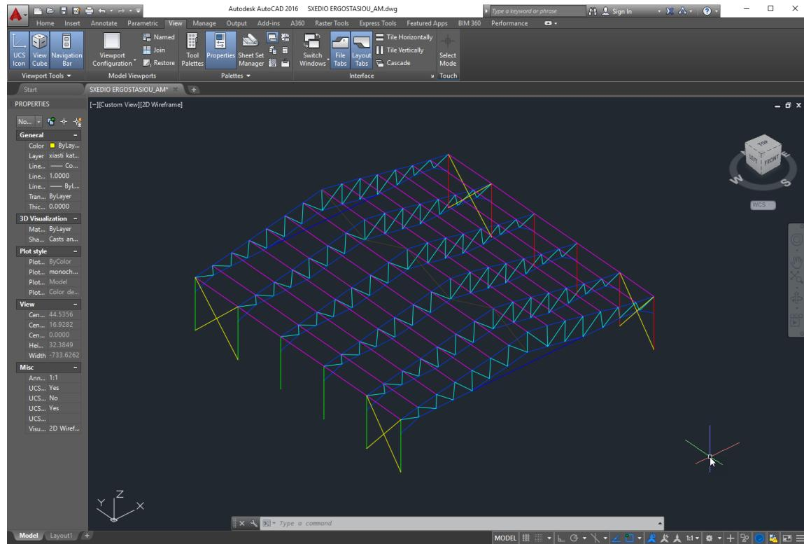
Για το συγκεκριμένο παραδειγμα χρησιμοποιείται το σχέδιο του δικτυώματος της πιο πάνω εικόνας. Πρόκειται για ένα δικτύωμα ενός ανοίγματος με 6 ζυγώματα. Στο 1ο και στο 5o πλαίσιο υπάρχουν χιαστή αντιανέμια και στις δύο πλευρές, και τεγίδες στη στέγη.
