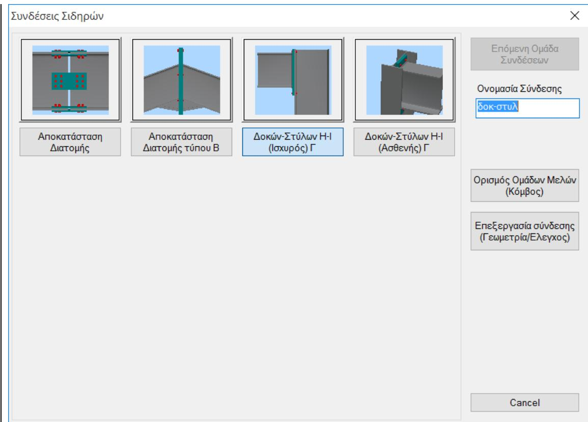
Επιλέξτε για παράδειγμα διαδοχικά το μέλος 30 (υποστύλωμα) και το μέλος 154 (δοκός). Με δεξί κλικ εμφανίζεται το παράθυρο με τους 4 πιθανούς τύπους συνδέσεων. Επιλέγετε την τελευταία (προς τα δεξιά) σύνδεση η οποία αντιστοιχεί σε σύνδεση Δοκού – Στύλου διατομών τύπου Η ή Ι στον ισχυρό άξονα. Ακολούθως θα πληκτρολογήσετε ένα όνομα για τη συγκεκριμένη σύνδεση.
