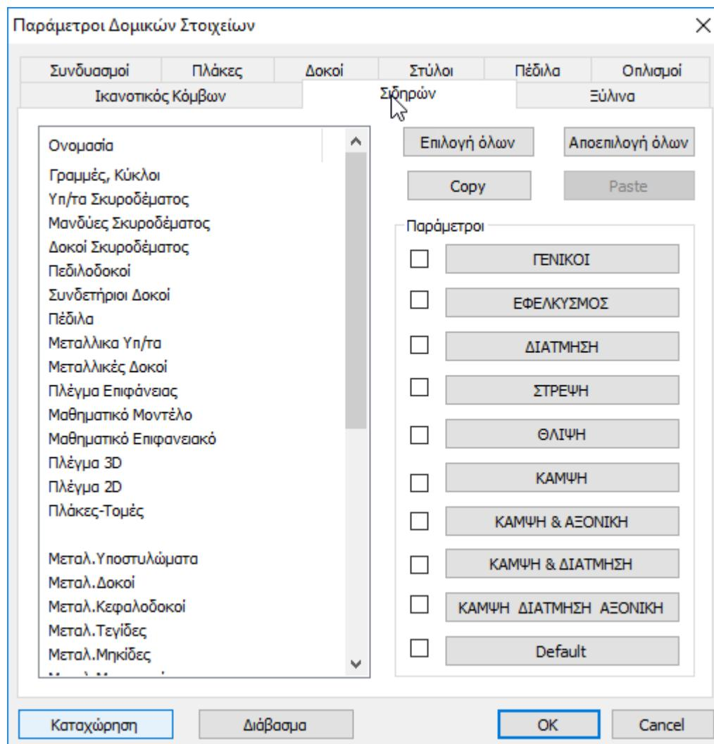
Ο ορισμός των παραμέτρων διαστασιολόγησης των μεταλλικών διατομών γίνεται ανά layer. Επιλέγετε το layer του οποίου θέλετε να ορίσετε τις παραμέτρους (πχ Μεταλλικά Υπ/τα) και ανά κατηγορία ελέγχου (Γενικοί, Εφελκυσμός, Διάτμηση κλπ), ορίζετε τις αντίστοιχες παραμέτρους. Αφού ορίσετε τις παραμέτρους για ένα layer, το πρόγραμμα σας δίνει τη δυνατότητα να αντιγράψετε αυτές τις παραμέτρους σε ένα άλλο layer με τη λογική του Copy και Paste.
