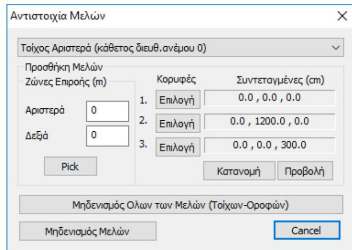
Στο κομμάτι που αφορά τον παλιό ορισμό των επιφανειών επιρροής δεν έχει αλλάξει κάτι όπως και η λειτουργία του πλήκτρου “Pick” όπου κρύβεται το πλαίσιο διαλόγου και εμφανίζει τις υπάρχουσες επιφάνειες επιρροής, έχει παραμείνει η ίδια.
