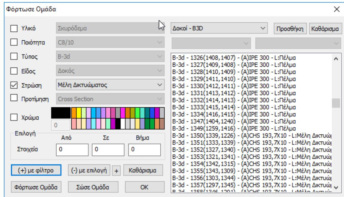
Οκ και δεξί κλίκ για να ανοίξει το παράθυρο των Πολλαπλών Επιλογών, και στις Ελευθερίες Μελών να τσεκάρετε τη Μγ αρχής και τέλους για τη Στρώση Πέλμα και τη Στρώση Μέλη Δικτυώματος, και να ολοκληρώσετε με Apply και Exit.
