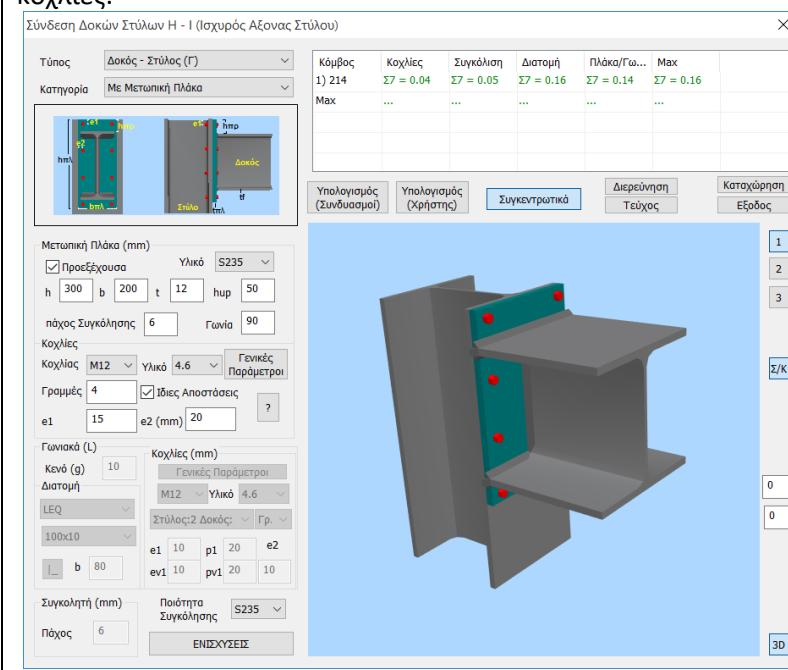
Όταν ικανοποιηθούν οι έλεγχοι της γεωμετρίας και της τοπολογίας της σύνδεσης, το πρόγραμμα θα κάνει όλους τους απαιτούμενους υπολογισμούς και θα εμφανίσει όλους τους ελέγχους που εκτελούνται με βάση ευρωκώδικα 3 για τη συγκεκριμένη σύνδεση.
