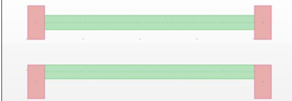
Επιλέγοντας τη δοκό με αριστερό κλικ σε ένα κεντρικό σημείο της πάνω πλευράς, και μετά την πάνω πλευρά των δύο στύλων, η δοκός τοποθετείται όπως στην εικόνα 1.
