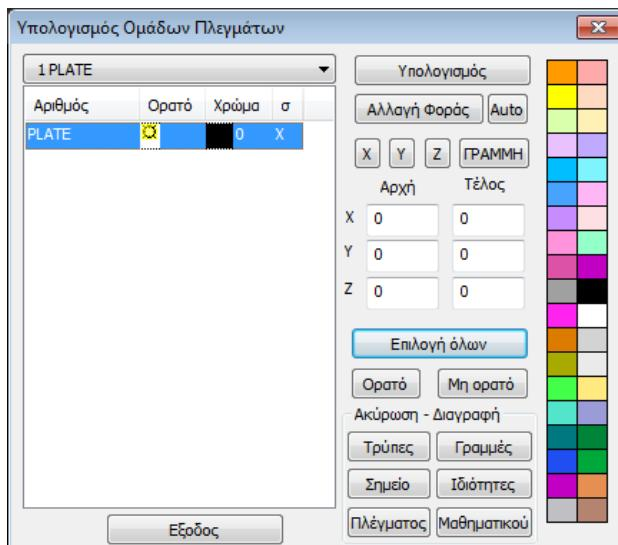
Επιλέξτε το πλέγμα και κατόπιν “Υπολογισμός” για να υπολογιστεί το “Meshing”
