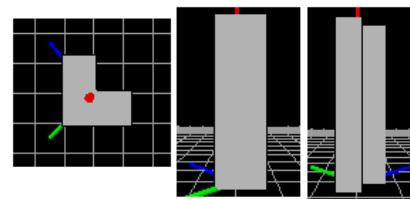
Στο παράθυρο σχηματίζεται η διατομή του υποστυλώματος που διαμορφώνεται με βάση τη γεωμετρία που έχετε επιλέξει και τις διαστάσεις που έχετε εισάγει. Εδώ επίσης βλέπετε τους τοπικούς άξονες γγ και zz της διατομής και μπορείτε να επιλέξετε το σημείο εισαγωγής της (μπλε σημεία). Το επιλεγμένο σημείο εισαγωγής είναι χρώματος κόκκινου.
