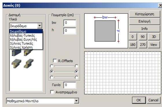
Επιλέγετε πρώτα από τη λίστα **Δοκός** το αν η διατομή που θα εισάγετε θα είναι δοκός ή υποστύλωμα. Πιέζοντας το πλήκτρο **“Διατομή”** εμφανίζεται αντίστοιχα η μάσκα εισαγωγής δοκού ή στύλου όπου πληκτρολογείτε τα στοιχεία, με βάση τα ούτα αναφέρθηκαν στο αντίστοιχο εδάφιο, όπου επιλέγετε υλικό,
