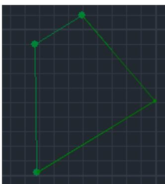
Στο πεδίο “**Κόμβοι**” μπορείτε είτε να πληκτρολογήσετε τον αριθμό των κόμβων του μεμονωμένου επιφανειακού, είτε να το αφήσετε κενό, και στην επιφάνεια εργασίας να επιλέξετε με αριστερό κλικ τους τέσσερις κόμβους που το συνθέτουν. Το στοιχείο θα σχηματιστεί στην επιφάνεια εργασίας.
