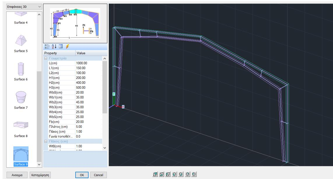
Το SCADA Pro προσφέρει πολλαπλές δυνατότητες για τη χρήση των 3D επιφανειακών μέσω των “Τυπικών Κατασκευών” και της “Αυτόματης Αναγνώρισης Όψεων”, εντολές που εξηγούνται αναλυτικά στη συνέχεια του ίδιου κεφαλαίου.
