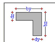
Τα τέσσερα πλήκτρα κάτω από το σχήμα του υποστυλώματος ορίζουν τη γωνία τοποθέτησης του σε μοίρες. Ανάλογα με την επιλογή το υποστύλωμα περιστρέφεται κατά 90°, 180°, 270°.
