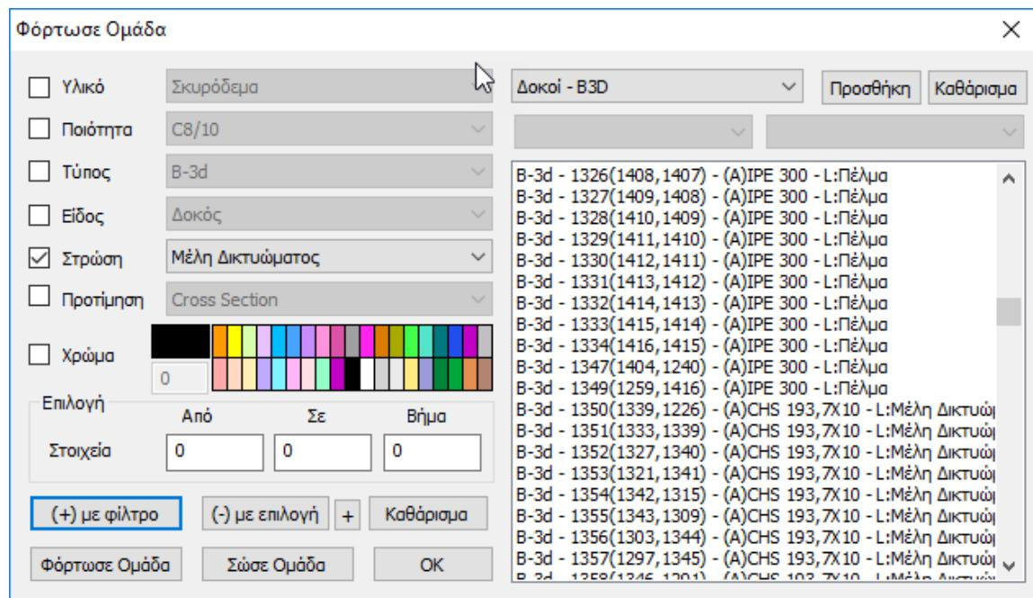
Οκ και δεξί κλίκ για να ανοίξει το παράθυρο των Πολλαπλών Επιλογών, και στις Ελευθερίες Μελών να τσεκάρετε τη Μζ αρχής και τέλους για τη Στρώση Πέλμα και τη Στρώση Μέλη Δικτυώματος, και να ολοκληρώσετε με Apply και Exit.
