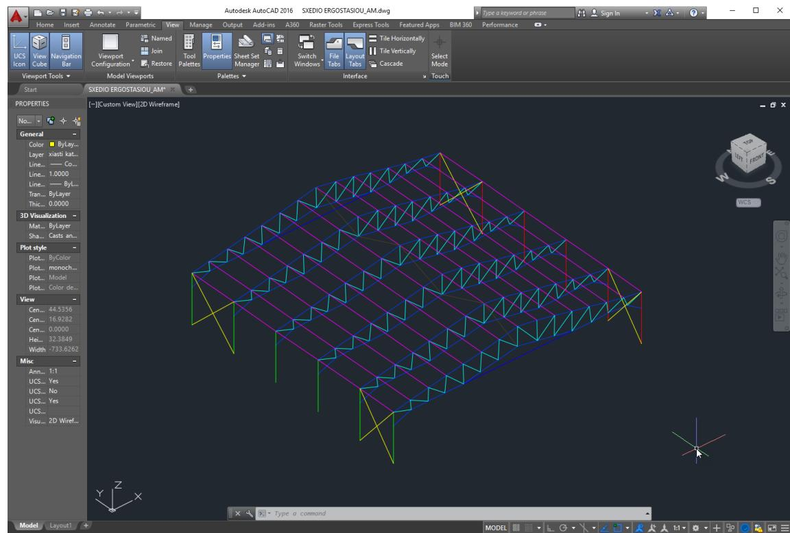
Για το συγκεκριμένο παραδειγμα χρησιμοποιείται το σχέδιο του δικτυώματος της πιο πάνω εικόνας. Πρόκειται για ένα δικτύωμα ενός ανοίγματος με 6 ζυγώματα. Στο 1ο και στο 5ο πλαίσιο υπάρχουν χιαστή αντιανέμια και στις δύο πλευρές, και τεγίδες στη στέγη.
