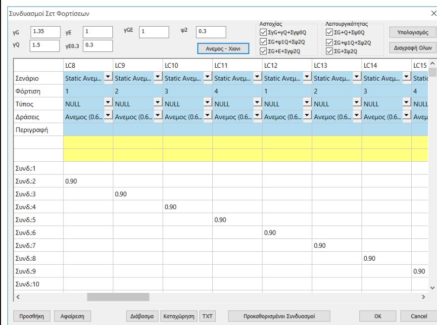
Επιλέξτε **Καταχώρηση** για το σώσετε ώστε να το χρησιμοποιήσετε για τη διαστασιολόγηση.
