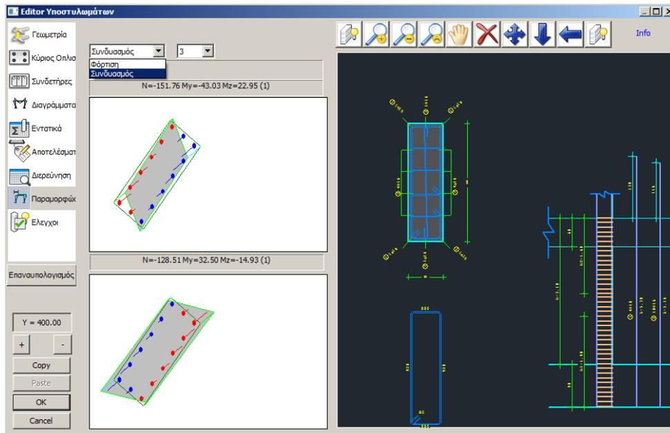
Στο πεδίο Παραμορφώσεις μπορείτε να δείτε πως παραμορφώνονται η άνω και κάτω διατομή του υποστυλώματος, σε κάθε φόρτιση και κάθε συνδυασμό, καθώς και τον οπλισμό που ανάλογα με το αν είναι θλιβόμενος ή εφελκυσμένος συμβολίζεται με μπλε ή κόκκινο αντίστοιχα.
