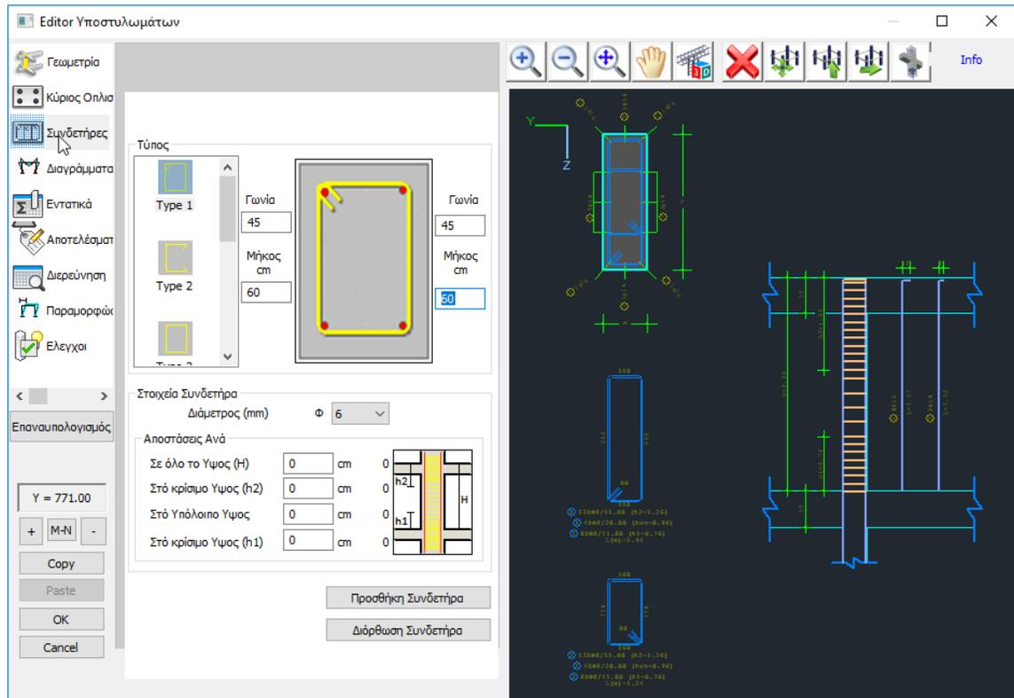
Στο πεδίο **Συνδετήρες** μπορείτε να πραγματοποιήσετε τροποποιήσεις και επεμβάσεις στους συνδετήρες του υποστυλώματος.
