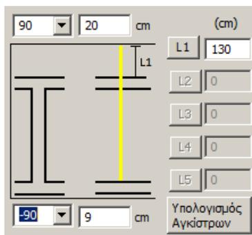
Σε όλους τους τύπους έχετε τη δυνατότητα να εισάγετε και Άγκιστρα άνω και κάτω. επιλέγεται τη φορά -90, +90 και Υπολογισμό Άγκιστρων για τον αυτόματο υπολογισμό, ή εισάγετε κατευθείαν τις δικές σας τιμές.
